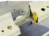
▼クロスメンバーをトランク側から見る。
