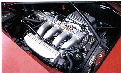
▲MR2のコクピットとエンジンルーム。3 S-GE型の直4 DOHCは、165ps / 6800rpmの最高出力を誇る。
